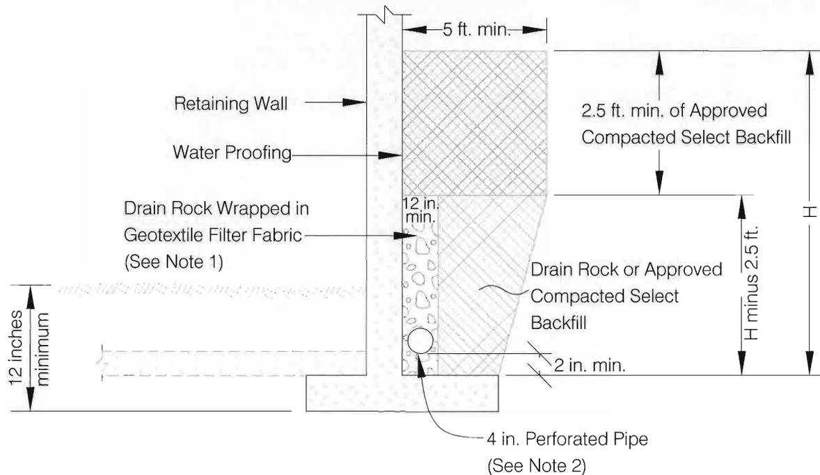
RETAINING WALL DRAINAGE DETAIL
